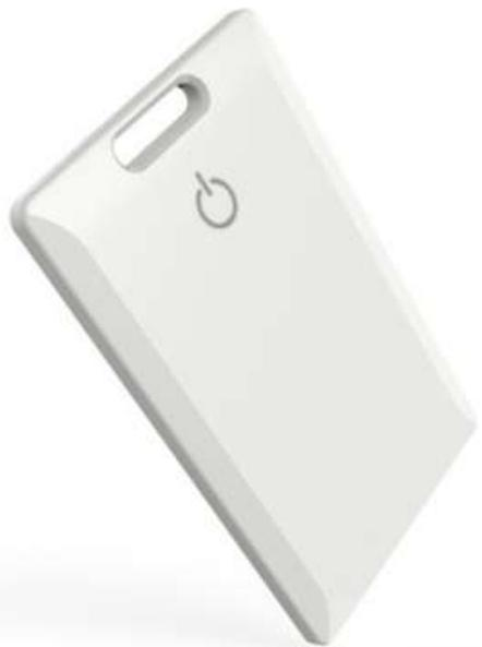
人员卡型信标/标签的工作频率为 2.45GHz，是新一代信标，搭载蓝牙 5.0 硬件平台，支持标准 iBeacon。标签同时结合了标准 iBeacon、Eddystone (UID、URL、TLM) 和加速计传感器 (可选)。隐藏按钮可用于紧急/紧急/SOS 需求。LF (125KHz)、HF (13.56MHz)、UHF (868~960MHz) RFID 功能也是可选的。
